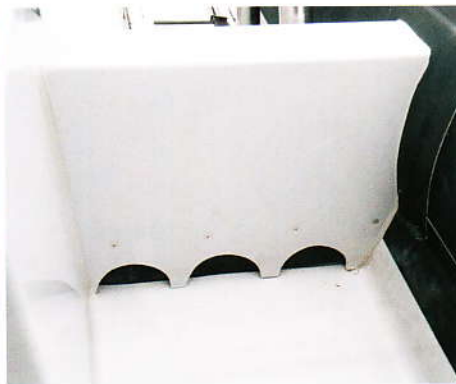
▲ Zagonetni otvori služe za odvod vode iz kokpita prilikom plovidbe teškim morem
